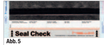
▲ Abb. 5: hawo Seal Check zur routinemäßigen Überprüfung der Siegelnahte.
