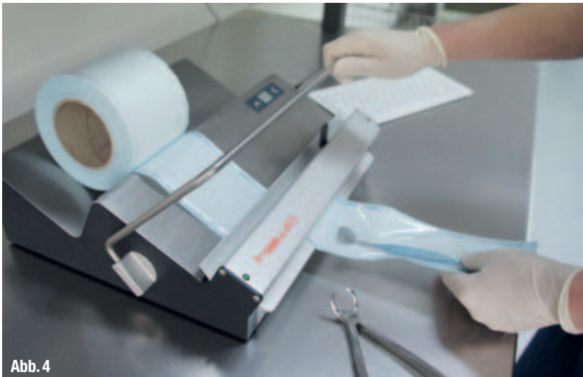
▲ Abb. 4: Validierbares Balkensiegelgerät (hawo hd 380 WSI-V ValiPak (R)).
