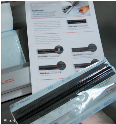
Abb. 4a–b: Scharfkantige Instrumente oder spitzes Füllgut müssen separat gesichert werden. – Abb. 5: Bei Öffnen der Verpackung muss diese immer „aufgepeelt“ werden. Instrumente dürfen niemals durch die Verpackung gebrochen werden. – Abb. 6: Tägliche Überprüfung der Siegelgeräte mittels Siegelindikator.
